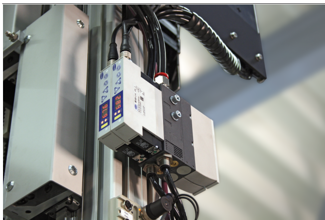
Generazione di vuoto centrale mediante gli eiettori compatti SMPi
